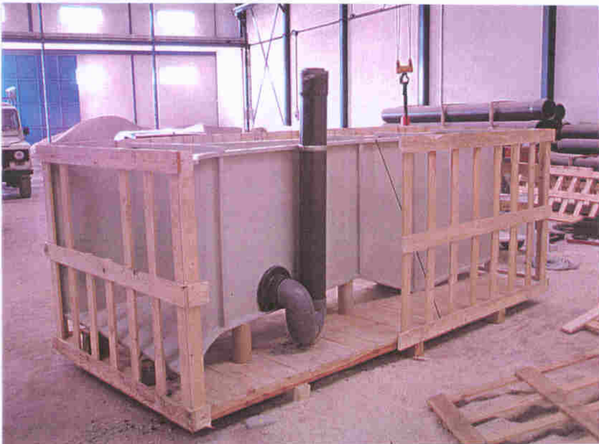
- Canal tipo Parshall de 12" instalado en Fuente de Santiago (Estepa).
