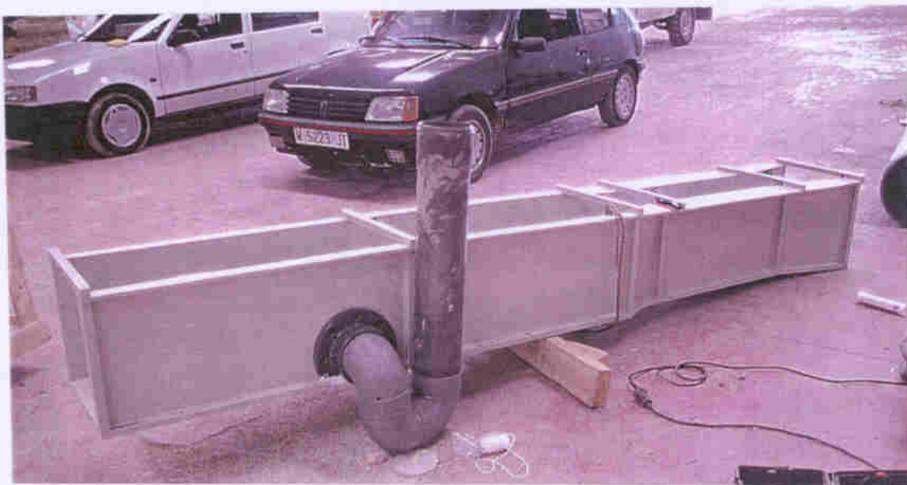
- Canal rectangular de 9" con vaso comunicante para la instalación de "datalogger" (MDS-Floater).
