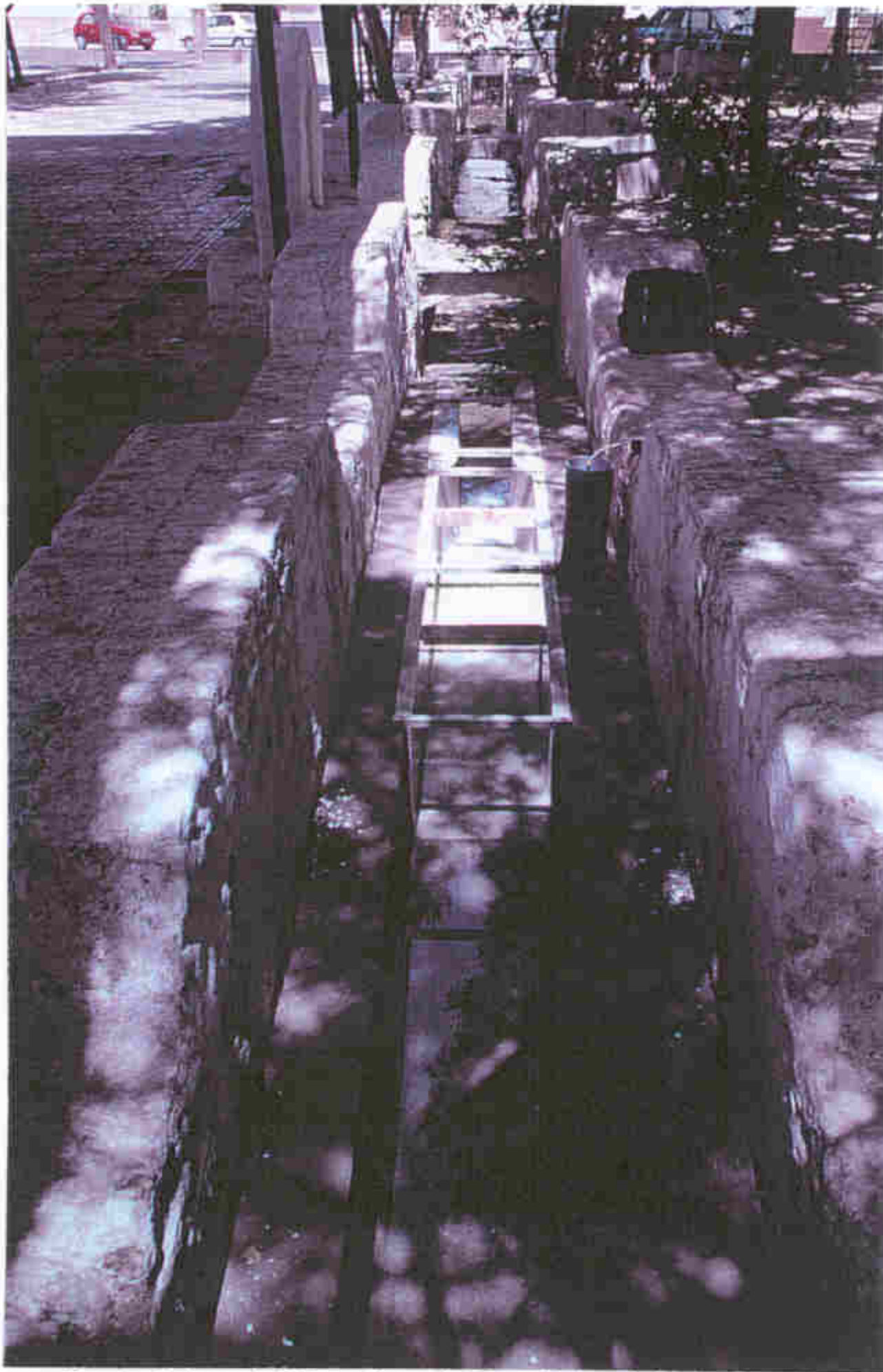
- Fuente de Lora de Estepa (Lora de Estepa). Canal de aforo de 9".
